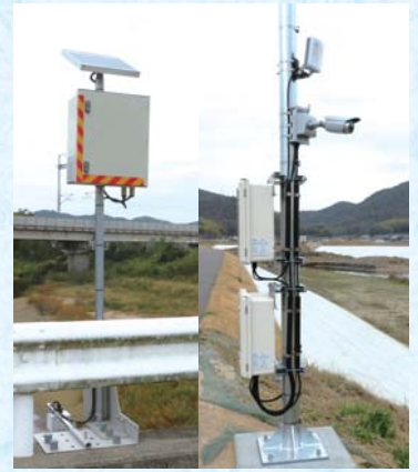
インターネットで砂川の現況確認ができる危機管理水位計(左)河川監視カメラ(右)槽部橋に新設
